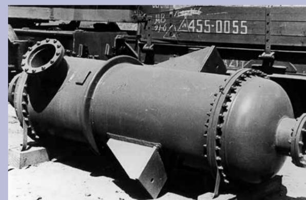
Теплообменник ТКВ вертикальный с линзовым компенсатором на кожухе. Vertical multipass TKV heat exchanger with shell bellow.
